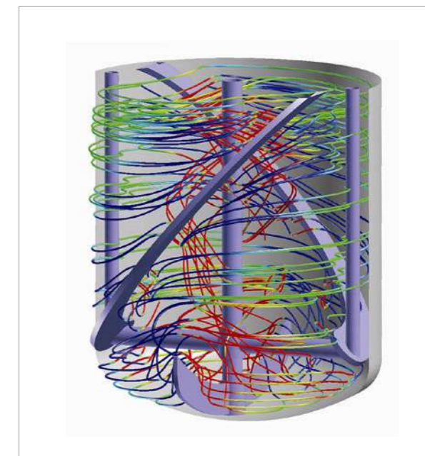
Figura 4. Simulación de agitación/movimiento bulk de reactor con agitación con paravisc .
